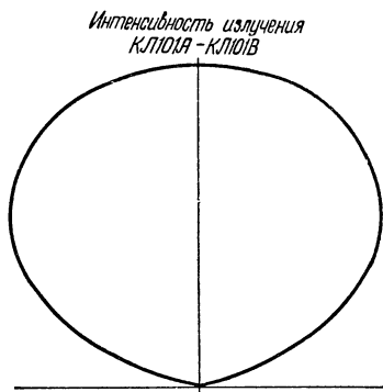
Рис. 3. Типовая характеристика направленности светового излучения светодиодов КЛ101
